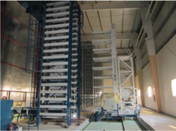
После формования на станке изделия осторожно передаются по клиноремному конвейеру на эскалатор с 18-ю ярусами
