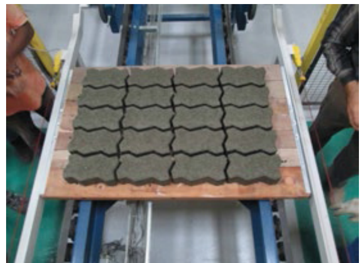
Используемые в оборудовании производственные поддоны выполнены из твердой древесины с высокой износостойкостью
