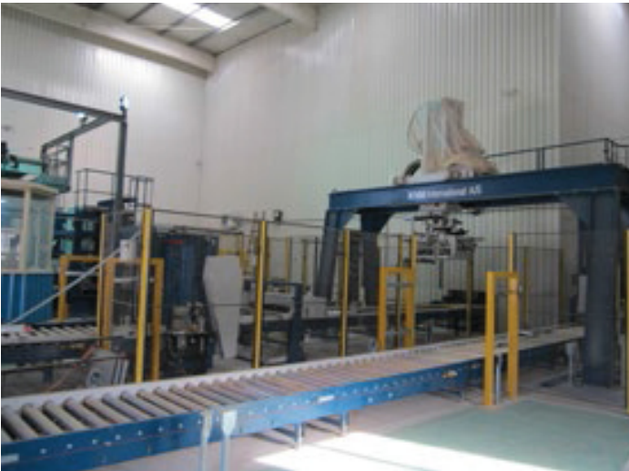
На разгрузочном конвейере возможна вертикальная и горизонтальная обвязка пакетов
