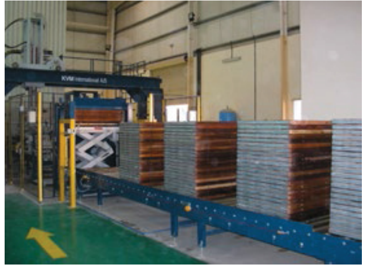
После разворота поддоны устанавливаются штабелями по 25 штук, затем автоматический перегрузчик перемещает их на изготовительный станок
